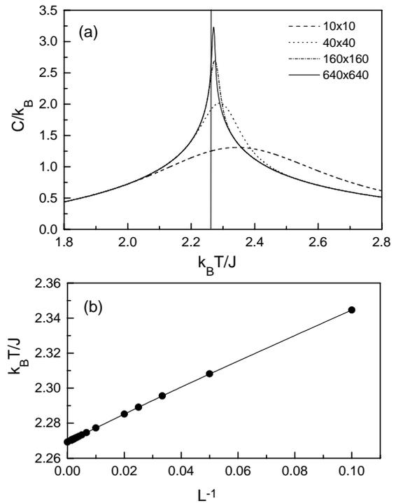
圖1. (a)正方形易行模型的比熱，(b)比熱最高點隨著晶格大小變化情形。
