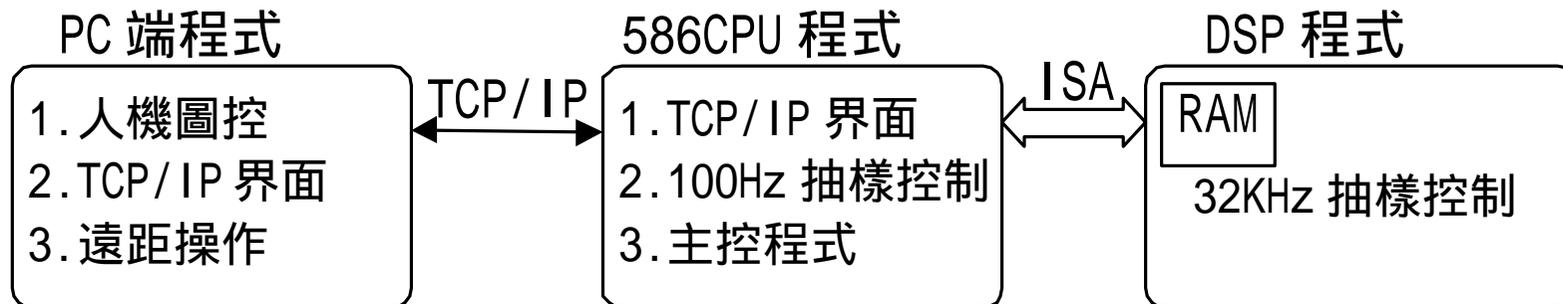
1. DSP核心部分負責即時控制程式，抽樣控制頻率可高達32KHz，完全不受Linux作業系統干擾。
